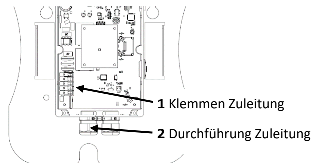
Abbildung 4 Klemmstellen innerhalb der Wallbox
